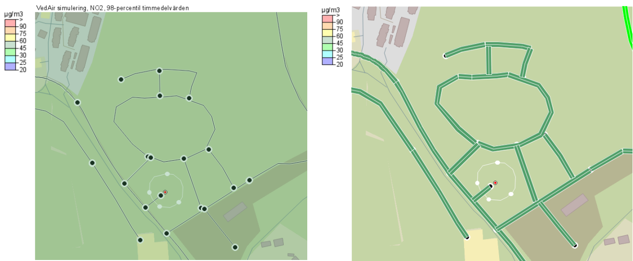
Figur 11. NO 2 som 98-percentil timme. T.v. beräknat med SIMAIR korsning för det utbyggda förslaget med prognoserade trafikflöden och emissionsfaktorer. Parkeringshuset representeras som en punktkälla och markeras med en röd prick i figuren. T.h. beräkningar i SIMAIR väg.
