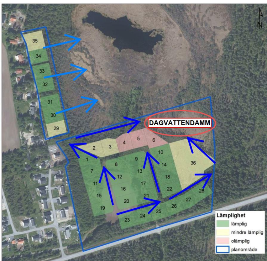
Figur 7. Föreslagna åtgärder för infiltration av dagvatten. Mörkblå pilar visar föreslagna lägen för svackdiken för avledning av dagvatten till dagvattendamm. Ljusblå pilar visar rinnvägar för föreslagna vattenutkastare i den norra delen av planområdet.
