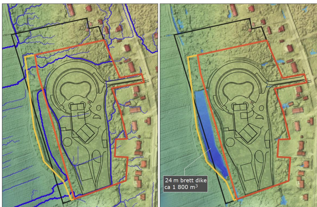
Figur 18. Skyfallsanalys efter exploatering för att omhänderta minst 1 800 m 3 . Figur till vänster illustrerar rinnvägar och figur till höger lågpunkter/instängda områden med föreslagen höjdsättning. Svart linje – Utredningsområde, Röd linje – skolområde och gul linje – natur.
