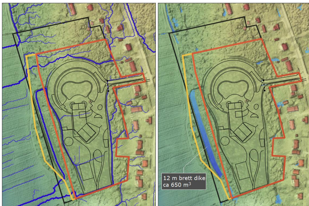
Figur 17. Skyfallsanalys efter exploatering för att omhänderta minst 600 m 3 . Figur till vänster illustrerar rinnvägar och figur till höger lågpunkter/instängda områden med föreslagen höjdsättning. Svart linje – Utredningsområde, Röd linje – skolområde och gul linje – natur.
