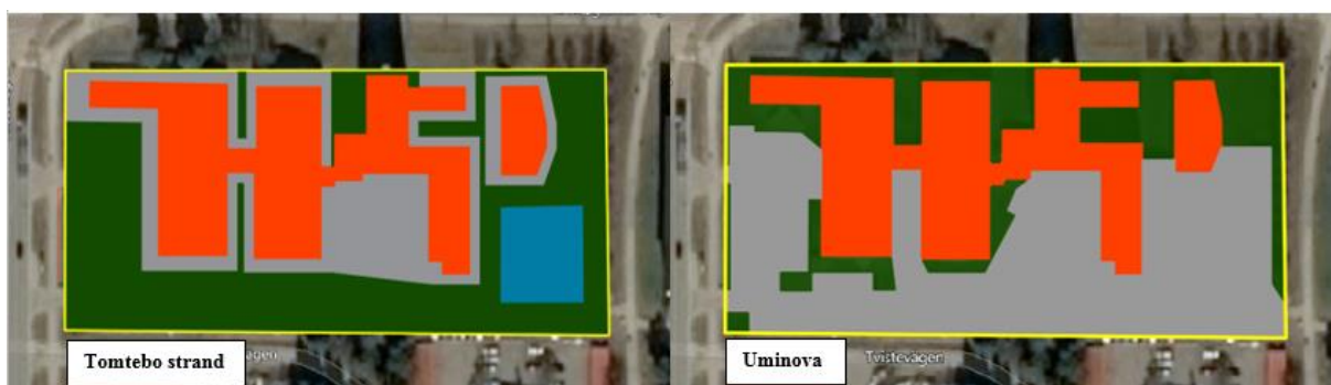
Figur 18. Befintliga markanvändningen för Uminova och samma område fast med Tomtebo strands grönare koefficienter. Orange är tak, grått är hårdgjort och grönt är grönyta. Blå markering symboliserar dammvolymer som behövs för att omhänderta dagvattnet.
