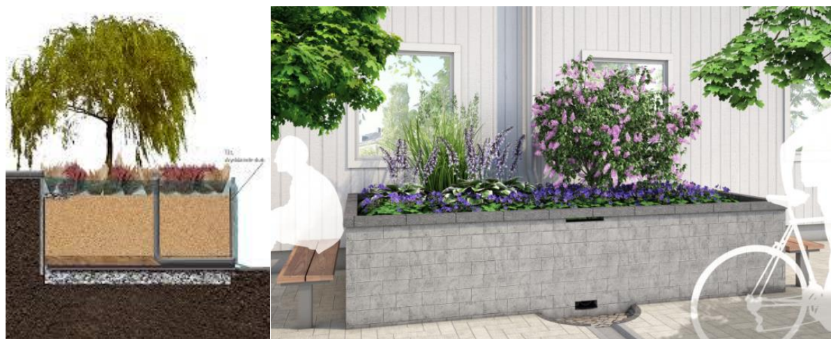
Figur 28 Till vänster: Principskiss över en regnbädds funktion i profil. Bild tagen från Åsa Wellanders examensarbete på SLU. Till höger: Exempelbild på växt-/regnbädd anpassad för att passa in i stadsmiljö. Bilden är tagen från Movium 2, 2015, illustration: Ten
