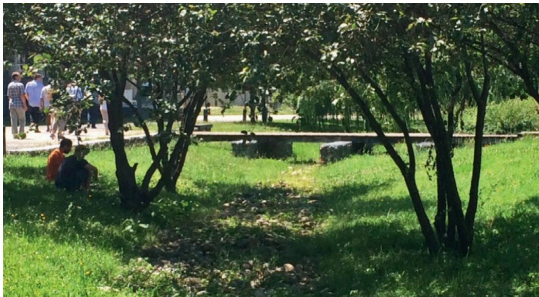
Figur 25. Exempel på översvämningsbara ytor. Översvämningsbara ytor står i regel tomma vid normalväder, men fylls i samband med stora regnhändelser. Bildkälla "Gröna dagvattenstråk" av LTU Dag&Nät, Grön Nano m.fl.
