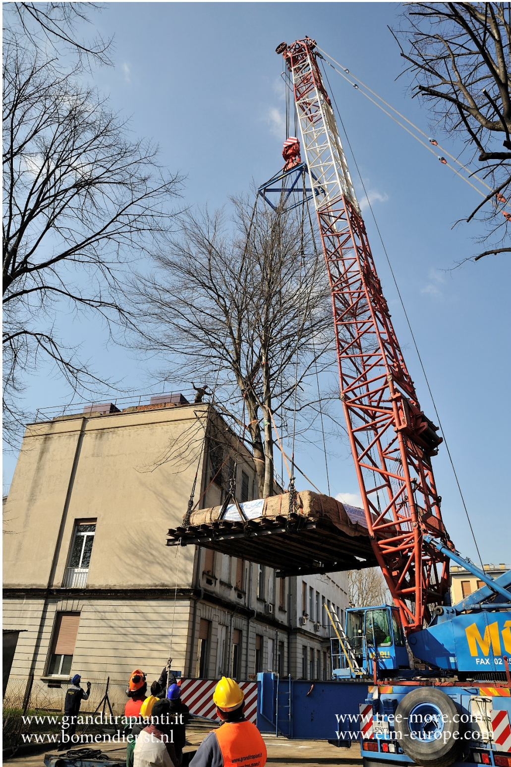
Figur 2. Flytt av stort träd med mobilkran. Foto: Francesco Maccazola.
