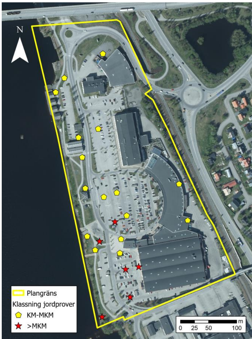
Figur 4. Karta över klassning av jordprover utifrån miljöteknisk jordundersökning utförd av Ramboll 2021. Gula markeringar = jordprover som överstiger riktvärden för känslig markanvändning. Röda markeringar = jordprover som överstiger riktvärden för mindre känslig markanvändning. I områdena med röda stjärnor har högre föroreningshalter påträffats än i de gula områdena.
