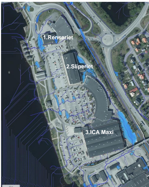
Figur 9. Skyfallsanalys över fastigheten Strömpilen 1 vid regn med 100 års återkomsttid. Kartan visar lågpunkter där dagvatten idag riskerar att bli stående vid händelse av skyfall samt ytliga avrinningsvägar genom området.
