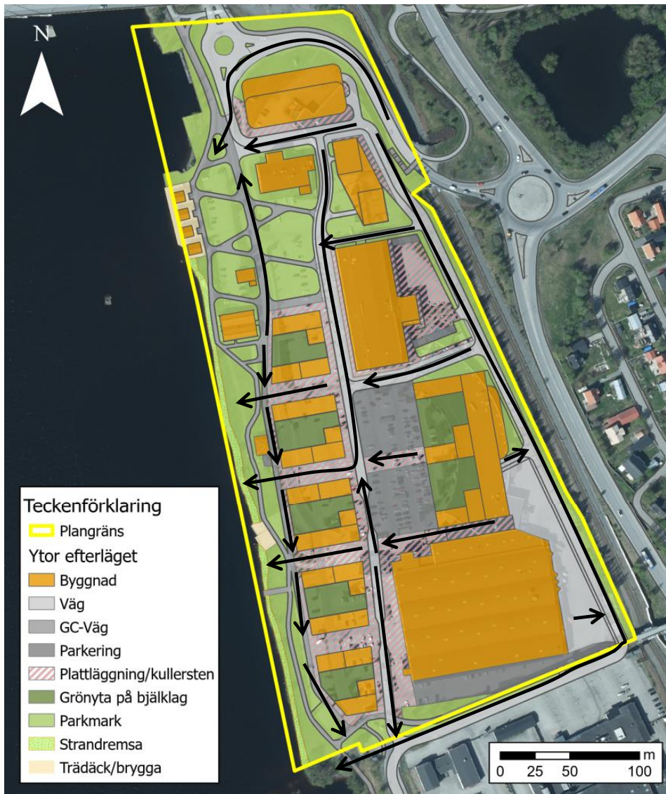
Figur 11. Karta över detaljplaneområdet med ytkartering enligt föreslagen situationsplan. Förslag på sekundära avrinningsvägar baserat på planerad kvartersstruktur och nuvarande marklutning i området.
