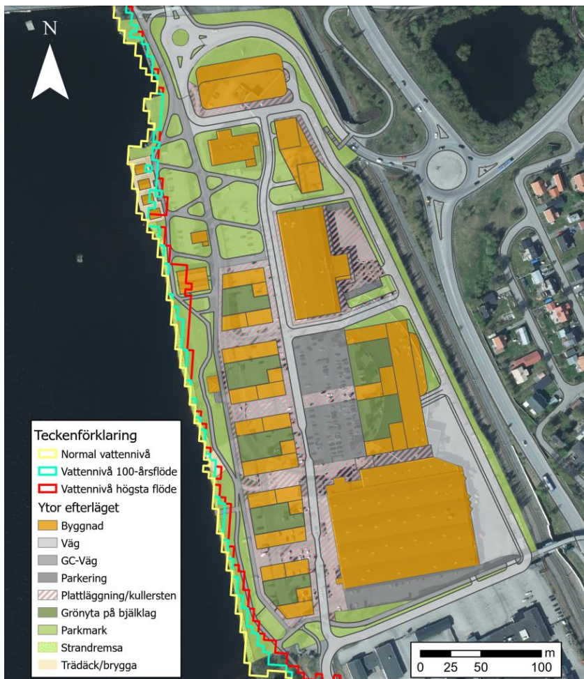
Figur 10. Karta över planområdet med ytkartering enligt föreslagen situationsplan. Normal vattennivå i gult, Vattennivå vid 100-årsflöden i cyan och vattennivå vid högsta flöde i rött
