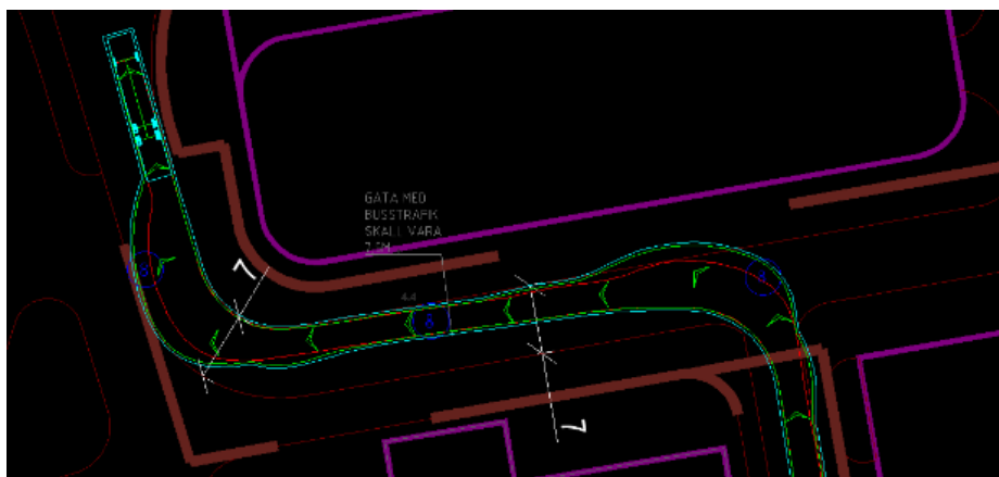
Figur 30. Boggibuss norrgående riktning, snitt 1.
